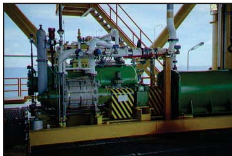
Компрессор NASH 2BG на морской буровой платформе
