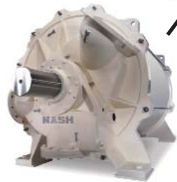
Duże Pompy Próźniowe z Pierścieniem Cieczowym (P2620 lub 2BE4) Korpus wyłożony poliizoprenem, specjalna konfiguracja wlotu i wylotu, wydajności do 39,000 m 3 /h
